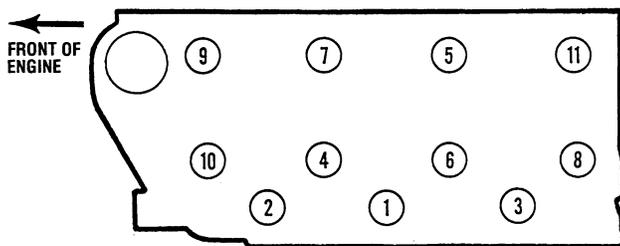
**CYLINDER HEAD BOLTS TIGHTENING SEQUENCE**
