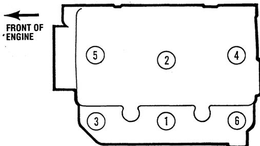
**CYLINDER HEAD BOLTS TIGHTENING SEQUENCE**
