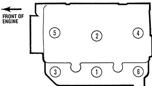
CYLINDER HEAD BOLTS TIGHTENING SEQUENCE
