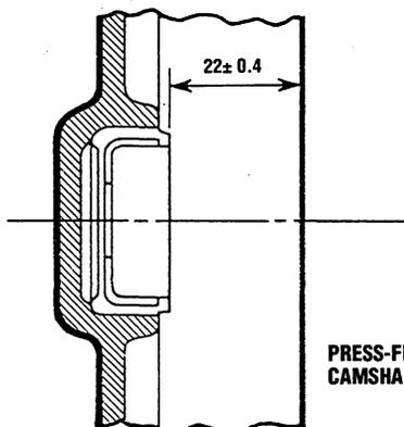
PRESS-FIT HEIGHT OF CAMSHAFT THRUST PLUG
