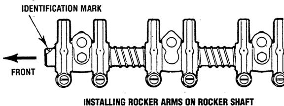
INSTALLING ROCKER ARMS ON ROCKER SHAFT
