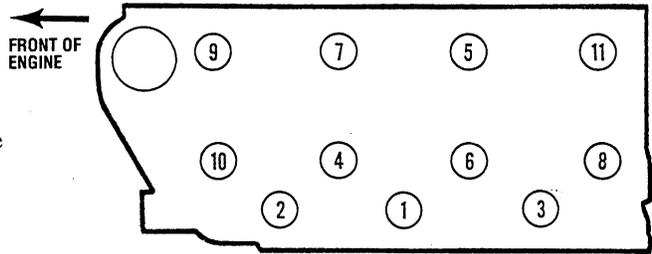
CYLINDER HEAD BOLTS TIGHTENING SEQUENCE
